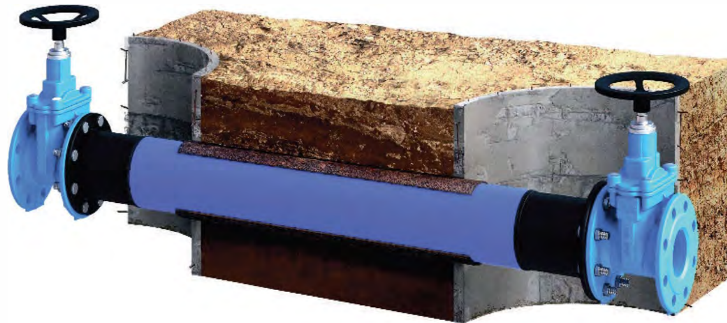
9 Монтаж запорной арматуры
