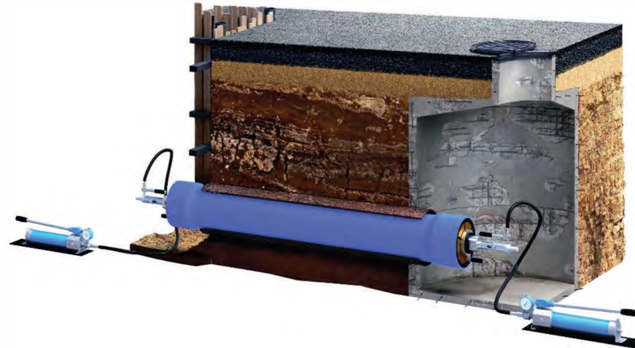
6 Реверсия ПЭ трубы
